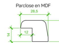
⇒ à recouvrement en MDF usiné en une seule pièce section 22 x 28.5
